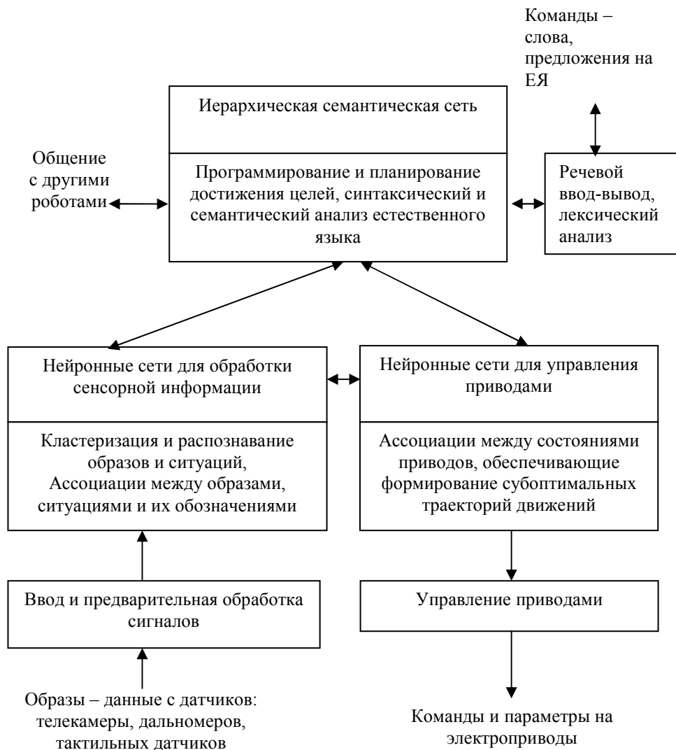
Рис. 2. Архитектура системы управления робота, ориентированная на естественно-языковое общение.
